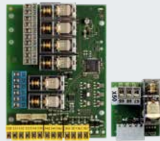
Rozširovacia doska pre ovládania: BK 150 FU E-1 (E FU H) AK 500 FUE-1 (E FU H)
